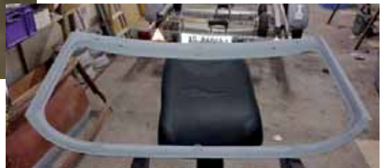
Rostfrei und grundiert
